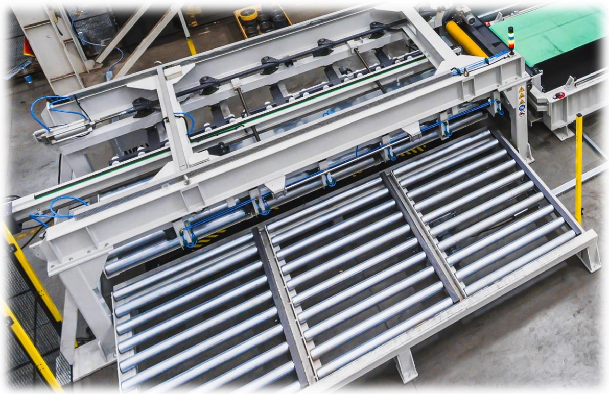
Rys. 5-8 – Moduł automatycznego układania arkuszy, przykład wykonania
